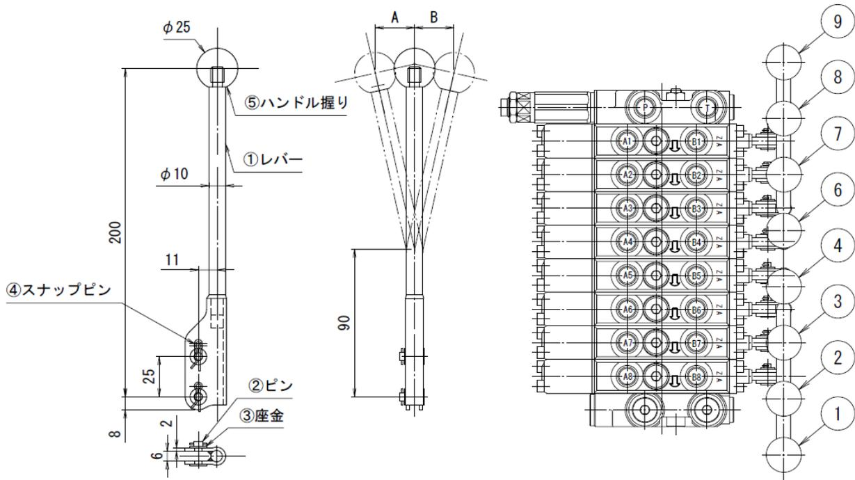
図 3-3 ハンドル部品一式図面例
